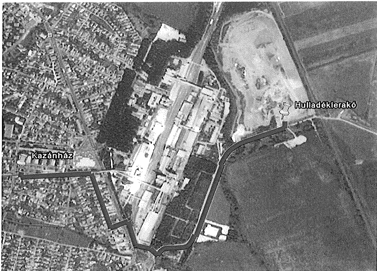
3. ábra: A kazánházig kiépített gázvezeték nyomvonala
